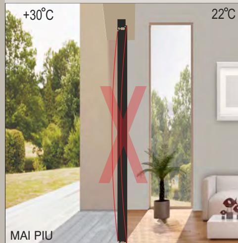
L'impatto delle condizioni climatiche sulle porte d'ingresso in alluminio in inverno ed estate, il cosiddetto effetto bi-lamina da origine ad una deformazione dell'anta che risulta in una chiusura difficile.
